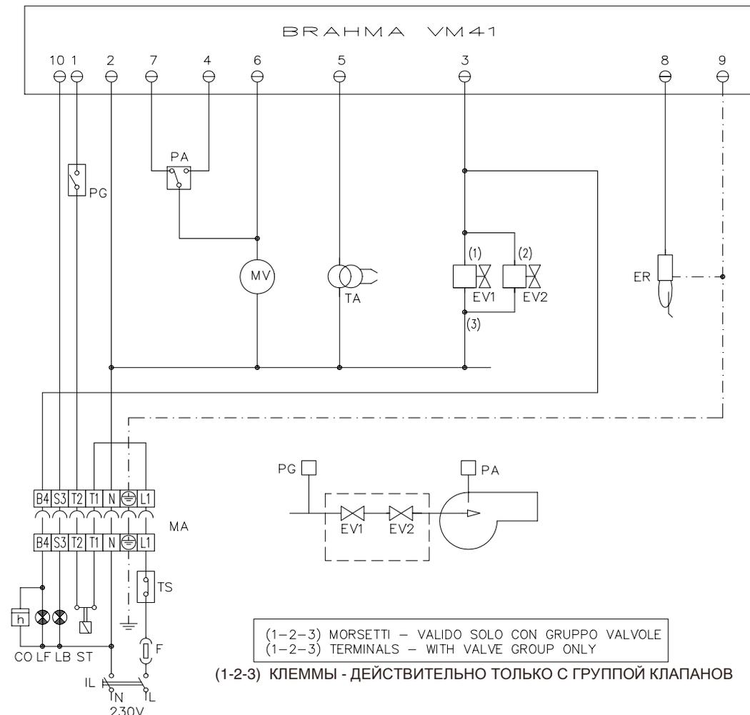
Электросхема код. 01-324/2 - Горелки типа S5 - S10 - S18
