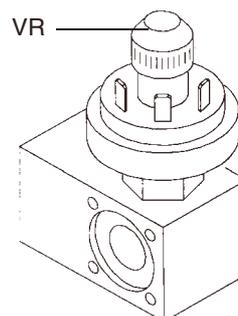
Рис. 25 - Pressostato SIT
